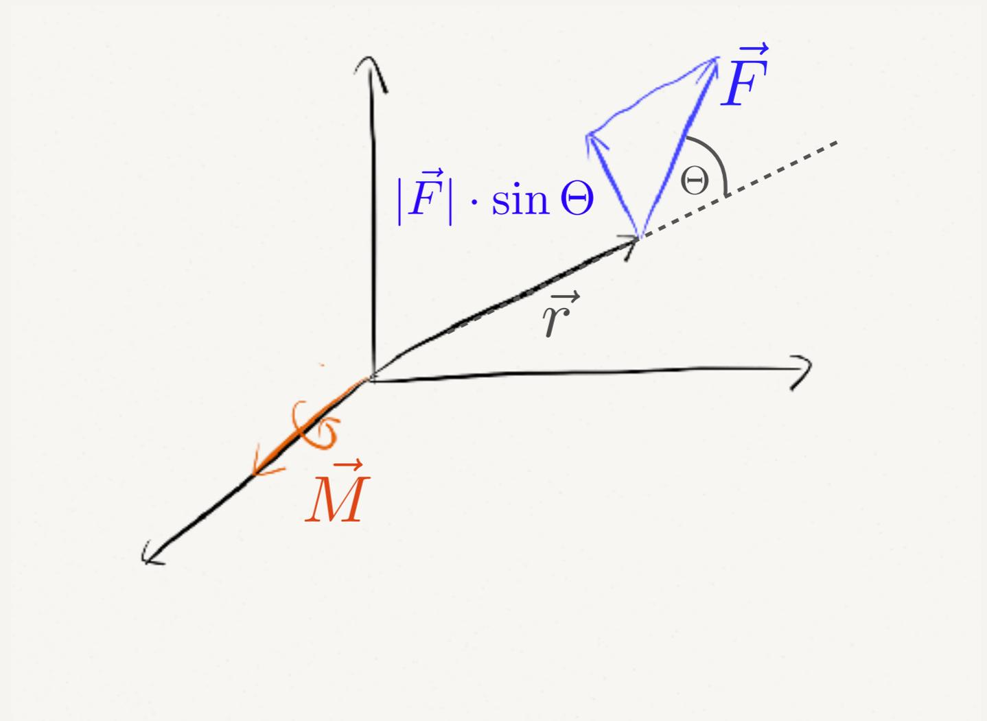
Die Projektion von F in die tangentielle Richtung ist bereits im Vektorprodukt enthalten!
