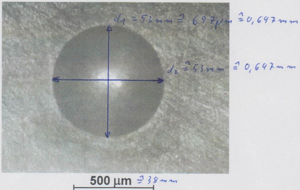
Eindruck-Kugel: 1,50mm ; Prüfmasse: 50 kg ; Einwirkdauer: 30s.
