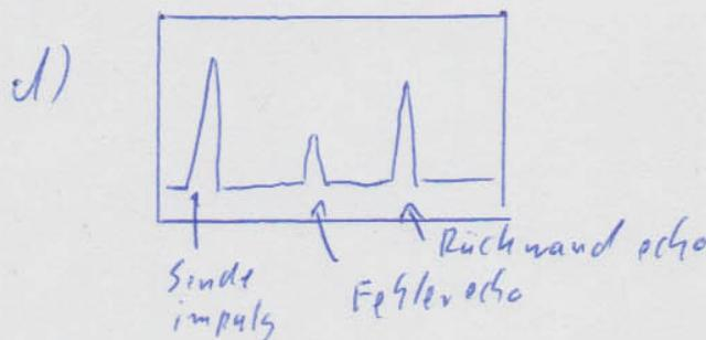
$$e) s_{\text{Fehler}} = \frac{v \cdot t}{2} = \frac{5092 \text{ m/s} \cdot 2 \cdot 10^{-6} \text{ s}}{2} = 5,092 \cdot 10^{-3} \text{ m} \approx \underline{5,1 \text{ mm}}$$
